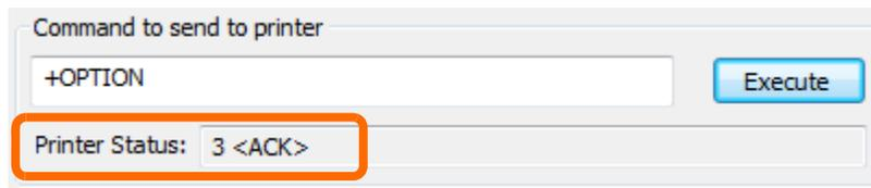
查阅下表，通过减去临近最高值的方式确定先前已安装的选配件。例如，如果打印机返回的数字是 3，临近最高值则为 2 — 以太网 PCBA。3 减去 2 得 1 — 磁条编码器。
